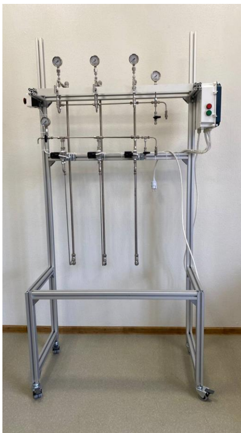
Рис. 1. а) Общая схема лабораторной установки КЦА; б) реальный внешний вид установки
