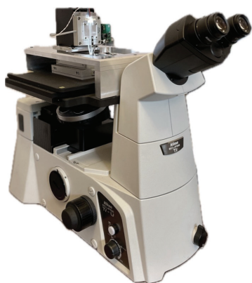
Рис. 1. Сканирующий капиллярный микроскоп ФемтоСкан Xi установлен на инвертированный оптический микроскоп Nikon Ti-U
