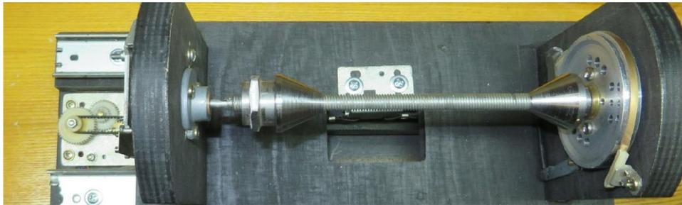
Рисунок 2.13 — (а) Установка для намотки соленоидов.
