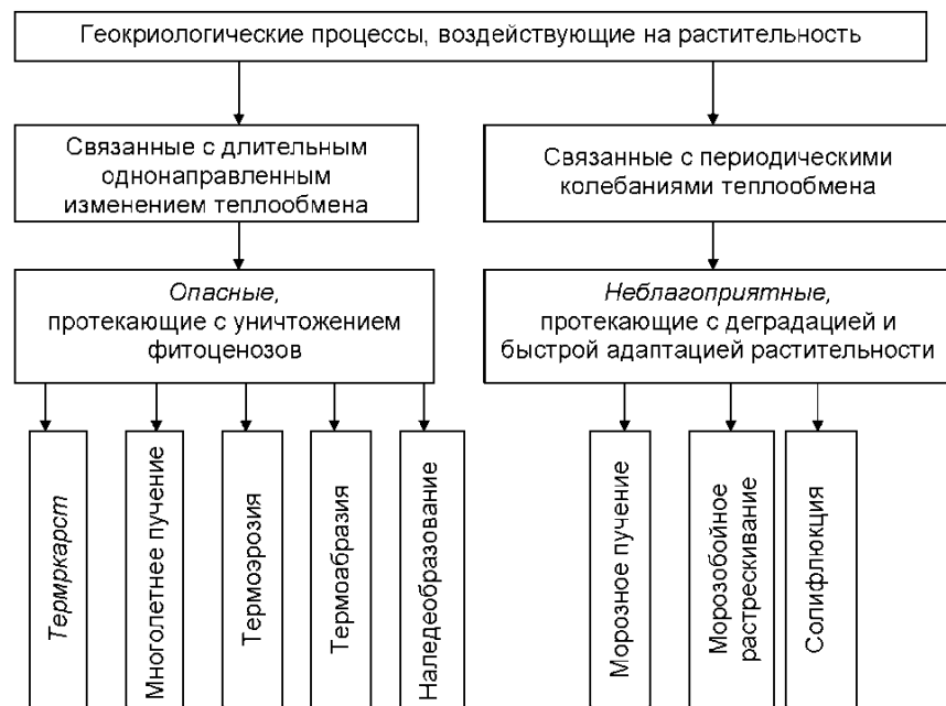
Рис. 3. Систематика геокриологических процессов по характеру воздействия на растительность. Курсивом показаны процессы, имеющие иное положение, чем на рис. 1.
