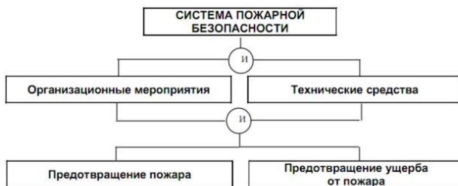
Рисунок – Компоненты системы пожарной безопасности [8]
