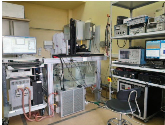
Рис. 2. Экспериментальный стенд. Слева – система управления излучателем; в центре – резервуар с дегазированной водой, в которую помещены излучатель, гидрофон и датчики температуры; справа – система сбора и обработки сигналов.
