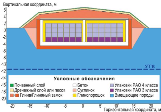
Рис. 1. Геометрия расчетной модели
