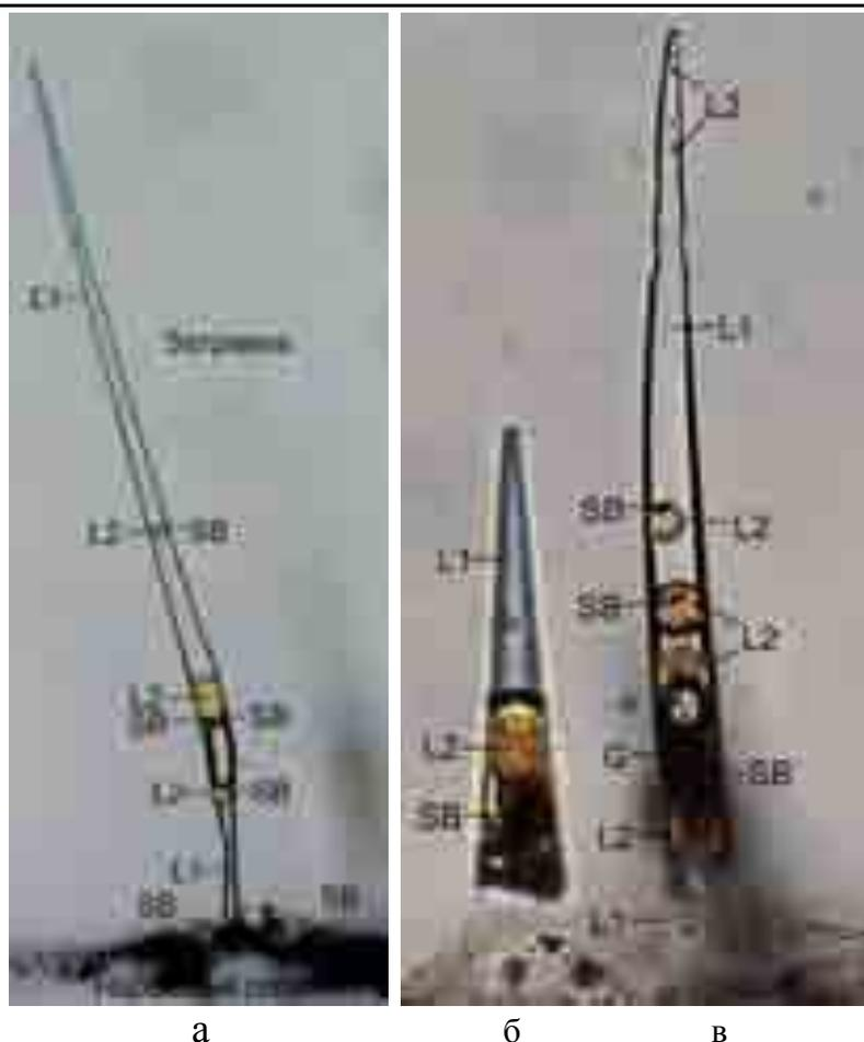
Рис. 17. Многофазные флюидные включения, демонстрирующие многократное увеличения количества твердых битумов по мере возрастания продолжительности опытов. Условия опытов: раствор 7,5 масс.  $\text{NaHCO}_3$ +5 об. % сырой нефти (Бавлинское месторождение), температура 290/300°C, давление 30 МПа; продолжительность: 180 (а), 200 (б) и 300 (в) суток.
