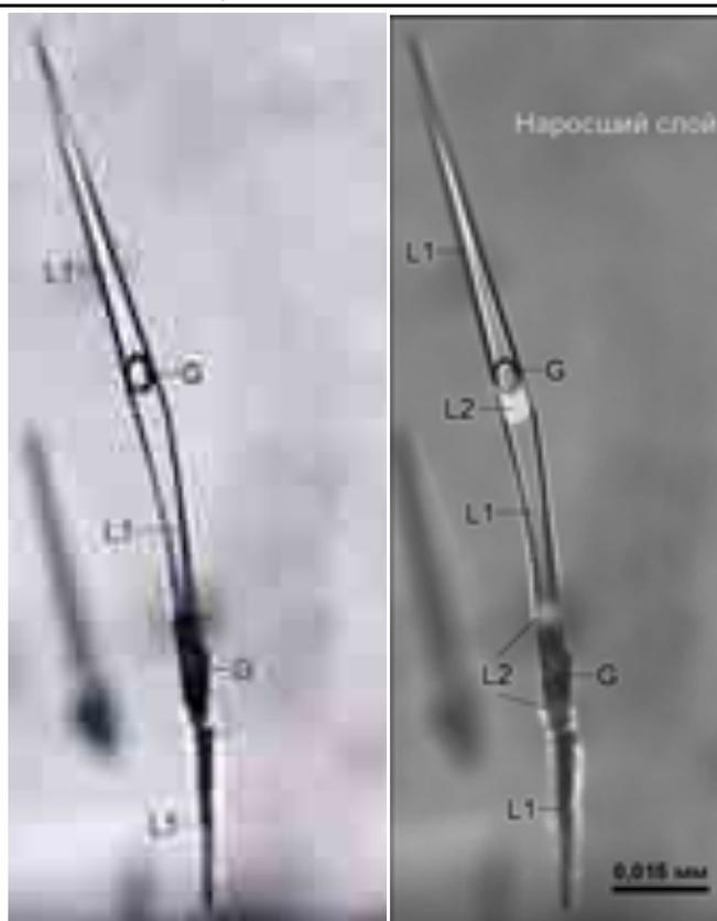
**Рис. 16. Флюидное включение с жидкими углеводородами в кварце, выращенном при взаимодействии нефти со слабощелочными гидротермальными растворами. а – в поляризованном свете; б – в комбинированном поляризованном и ультрафиолетовом свете. Температура 360/390°C, давление ~ 80 МПа. Бавлинское месторождение (Татарстан)**
