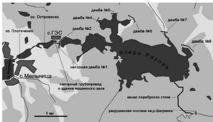
Схема гидротехнических сооружений озера Разлив и Боровно
