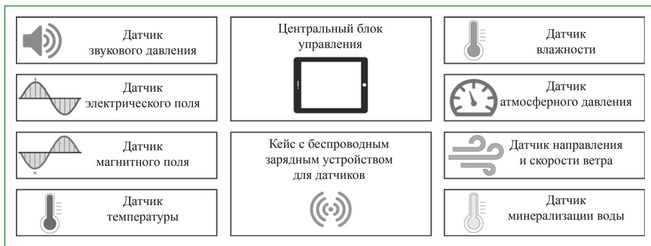
Рис. 1. Структурная схема комплекта оборудования
