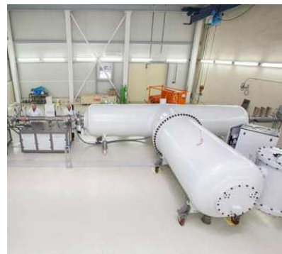
Рис. 4. Перезарядный ускоритель 3MV Tandetron 4130 MC+(HC) и его параметры
